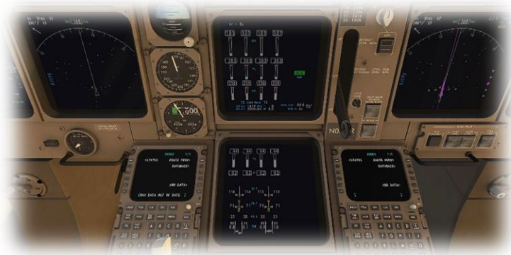
Indicateur de moteur et alerte de l'équipage système (EICAS)
