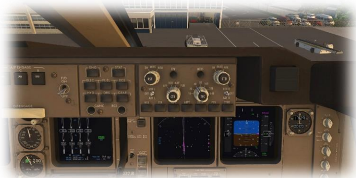
EFIS du copilote (Vol électronique Instrument Contrôle du système) Panneau
